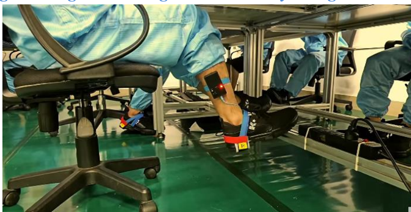
Thiết bị đeo ở chân để giám sát tĩnh điện theo thời gian thực. Ảnh: HSP Tek
