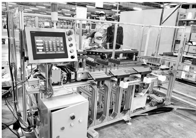
Hình ảnh thiết kế máy dập lỗ nhôm bán tự động (ảnh trái). Máy được ứng dụng sản xuất tại công ty TNHH Lixil
