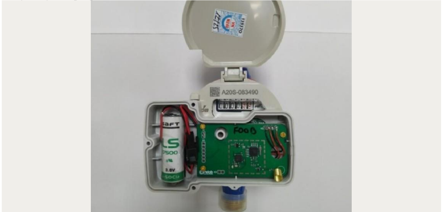
Hình ảnh thiết bị gắn vào mặt đồng hồ nước cơ. Ảnh: NVCC
