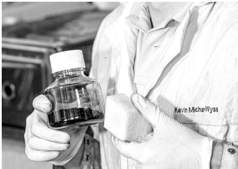
Một mẫu graphene được làm từ vật liệu nhựa thải và một mẫu xốp polyurethane gia cố bằng graphene
