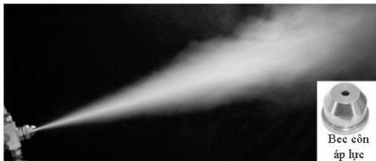
c) Vùng ảnh hưởng của vòi phun kiểu côn áp lực
