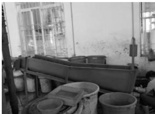
Hình 2: Sơ đồ thí nghiệm thu hồi quặng bauxit trong quặng đuôi thải
