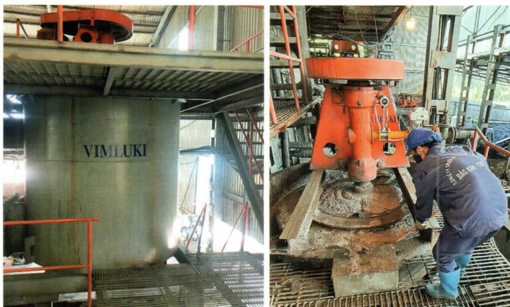
H. 5. Lắp đặt và chạy thử nghiệm thiết bị tuyển nổi tankcell chế tạo tại nhà máy tuyển chì kẽm Chợ Điện
