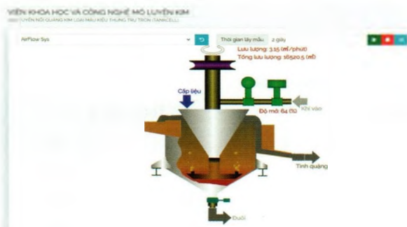
H. 6. Trang WEB giám sát hệ thống đo lường, điều khiển khí nén
