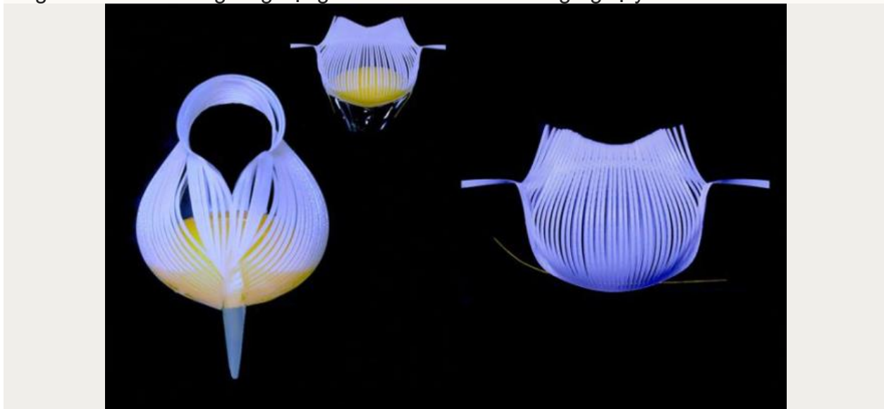
Kẹp robot có thể nâng lòng đồ trứng (trái) và sợi tóc người (phải).
