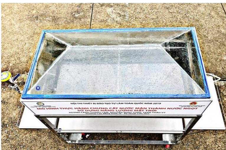
Phía trên khoang chưng cất là bốn tấm kính để đón lượng nhiệt mặt trời được nhiều nhất. Ảnh: NVCC
