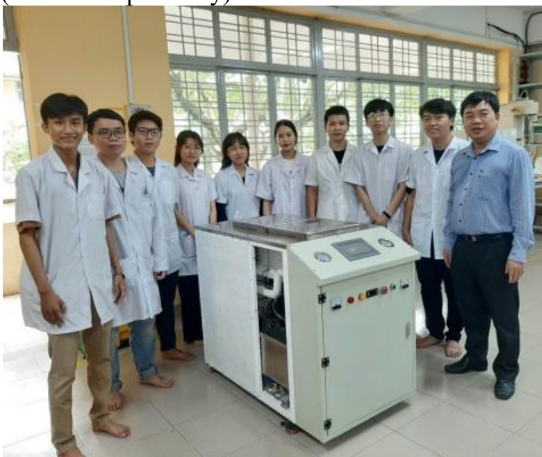
Máy cô đặc lạnh (CC-V2) và nhóm nghiên cứu, cô đặc nước ép trái cây giữ nguyên chất lượng sản phẩm như tự nhiên.
