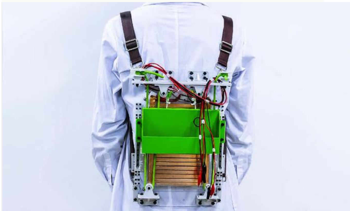
Bản thử nghiệm của mẫu ba lô có thể tạo ra điện. Ảnh: ACS Nano.
