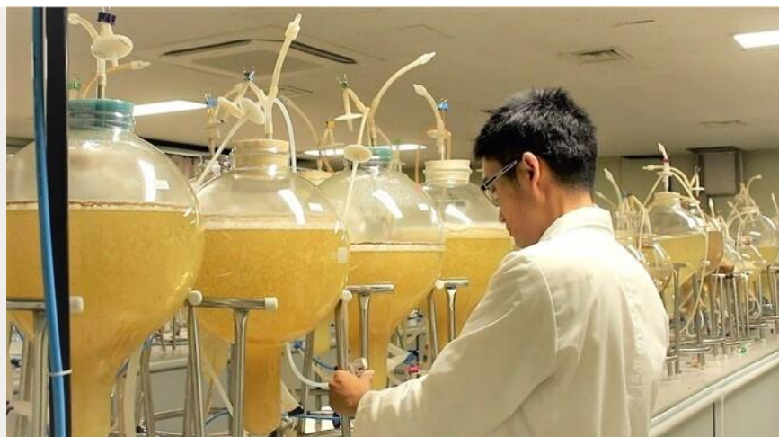
Hệ thống nuôi cấy sinh khối (mô, tế bào thực vật, cơ quan) để tạo được chất. Ảnh: NVCC.
