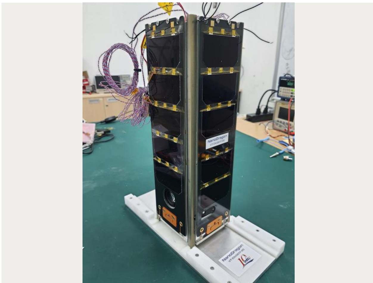
Vệ tinh NanoDragon đã hoàn thiện được tích hợp, thử nghiệm chức năng ở mức hệ thống. Ảnh: VNSC.
