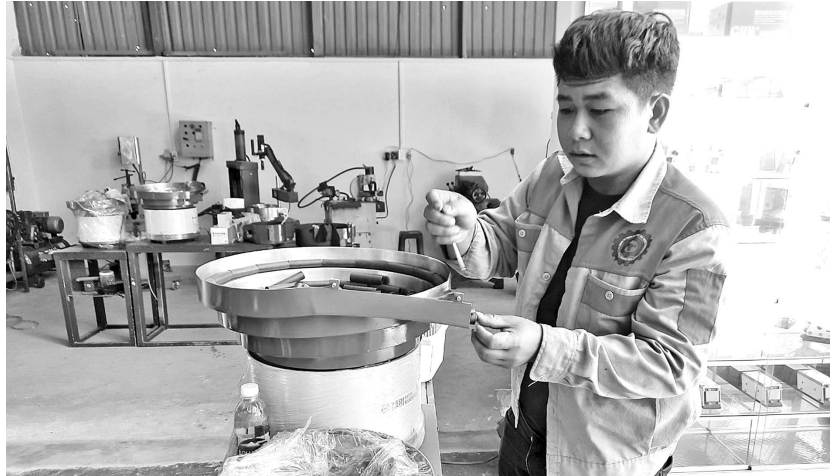
Kiểm tra sản phẩm phễu rung tự động trước khi xuất xưởng tại Công ty TNHH TMDV Sản xuất Quyết Thắng (TP.Biên Hòa)
